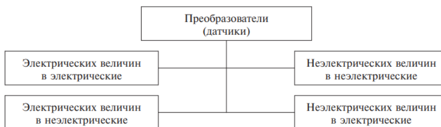
Рисунок Б.2 - Классификация преобразователей по виду входных и выходных величин.
